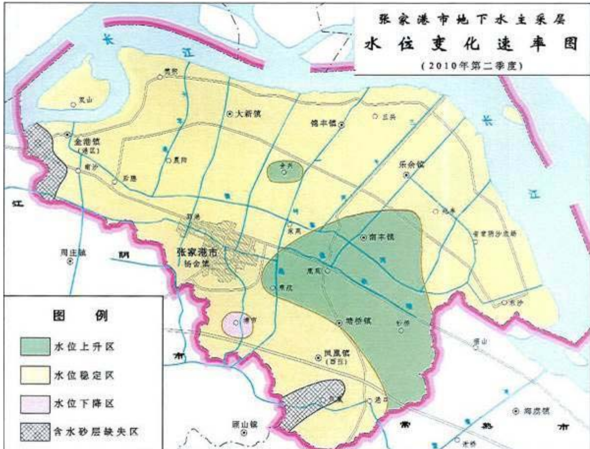
图5.2-3 地下水水位变化速率图
